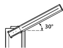
**!** Il valore del preacarico è indicativo per raggiungere il corretto angolo di equilibratura della barra / The preload value is indicative to reach the correct bar balance angle / La valeur de précharge est indicative pour atteindre l'angle d'équilibrage correct de la barre / Der Wert der Vorspannung ist ein Richtwert für die Erzielung des richtigen Ausgleichswinkels der Stange / El valor de precarga es indicativo para alcanzar el ángulo correcto de balance de la barra
