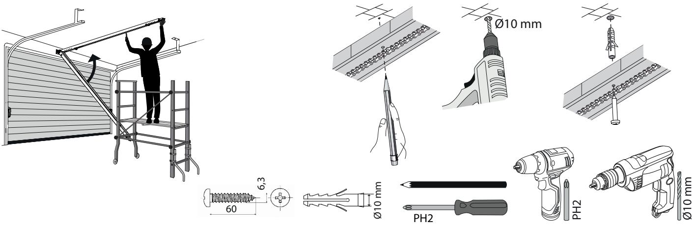
**E2 FISSAGGIO BINARIO A SOFFITTO CON STAFFE - CEILING RAIL FIXING WITH BRACKETS - FIXATION RAIL DE PLAFOND AVEC SUPPORTS : BEFESTIGUNG GLEIS AN DER ABDECKUNG MIT BÜGELN - FIJACIÓN DEL RIEL EN TECHO CON ESTRIBOS - BEVESTIGING SPOOR AAN PLAFOND MET BEUGELS**
