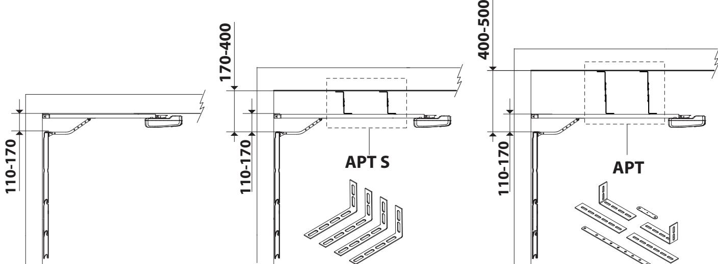
**3 CORRETTO FISSAGGIO DEL BINARIO IN CASO DI ARCHITRAVE SOPRA LA PORTA se non è possibile appoggiare il binario alla parete del sezionale:
