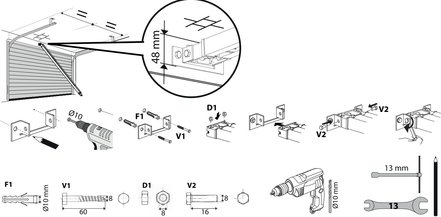
**E1 FISSAGGIO BINARIO A SOFFITTO - ASSEMBLY OF TRACK HOLDING BRACKET ONTO THE WALL - FIXATION RAIL AU PLAFOND BEFESTIGUNG GLEIS AN DER ABDECKUNG - FIJACIÓN DEL RIEL EN EL TECHO - BEVESTIGING SPOOR AAN PLAFOND**
