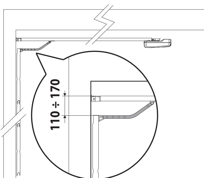
Si consiglia di fissare l'operatore in maniera tale da poter tenere il ramo anteriore della leva il più possibile orizzontale (vedere figura), fermo restando che andrà verificato, da parte dell'installatore, il rispetto della normativa riguardante gli impatti.
