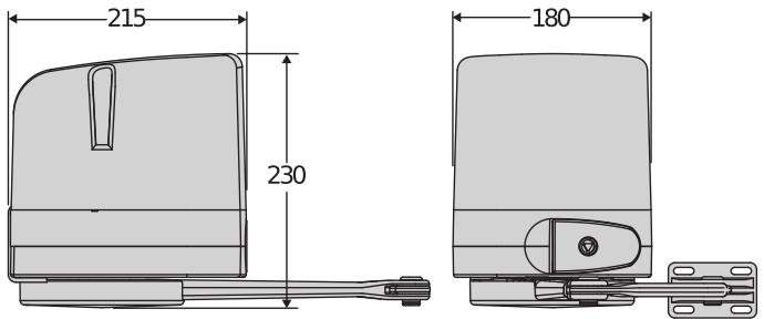
Azami 2 metre genişliğinde ve 200 kg ağırlığındaki kanatlı bahçe kapıları için uygun, mesken tipi kullanıma yönelik mafsallı kolu elektromekanik operatör.
