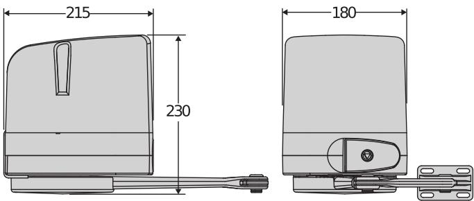
Электромеханический привод с шарнирным рычагом для использования в жилом секторе, для створок распашных ворот шириной до 2 м и весом до 200 кг.
