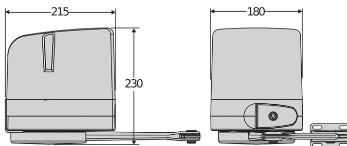
Operador eletromecânico com braço articulado de uso residencial para folhas de portões batentes até 2 metros e até 200 kg. Ideal para qualquer situação de instalação, permite resolver facilmente os problemas ligados aos pilares de grandes dimensões graças ao seu sistema de alavancas. Central de comando, fins de curso e bloqueios mecânicos de paragem integrados no operador.
