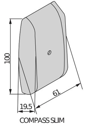
Система управления доступом, способная контролировать до 32 проходных в макс. 8 различных зонах с запретом повторного прохода по одной карточке.
