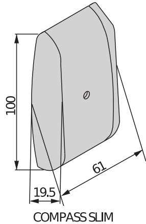
Systém řízení přístupu pro správu až 32 periferních pruchodu pro maximálně 8 různých zón s funkcí kontroly opakováního vstupu antipassback. Samostatně pracující jednotka, lze pripojit k osobnímu počítači přes USB za účelem řízení anebo programování.
