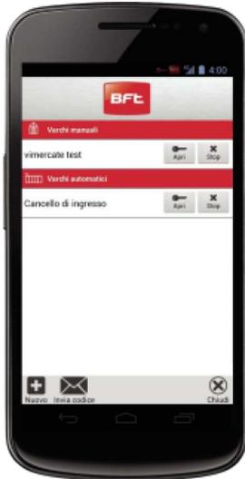
Innovadora aplicación para controlar accesos automatizados con un simple toque en un móvil o smartphone (sistema operativo Android o iOS). Funcionamiento tanto en modo manual, solicitando la confirmación del usuario antes de la apertura, como en modo automático, permitiendo la apertura con tan solo acercarse al paso.
