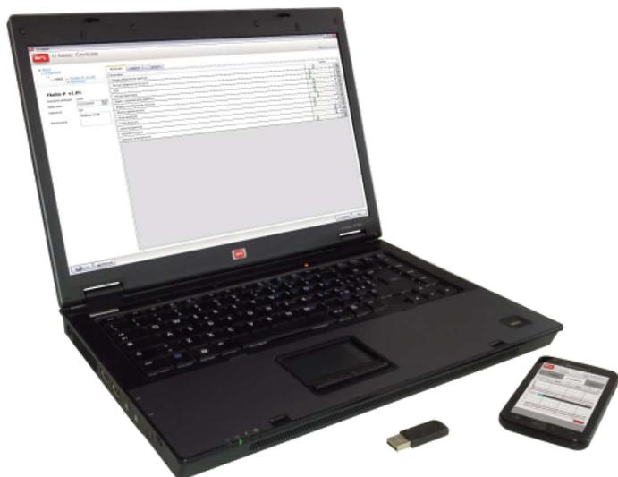
Určeno pro specifické potřeby instalačního technika pro jednodušší správu a údržbu vlastních zařízení, inovativní software U-Base se vyznačuje bezprostředním a intuitivním uživatelským rozhraním a je schopen pracovat on-line a aktualizovat data přímo na připojených systémech nebo v režimu off-line s činností podle informací obsažených v lokální databázi počítače, na kterém je nainstalován.
