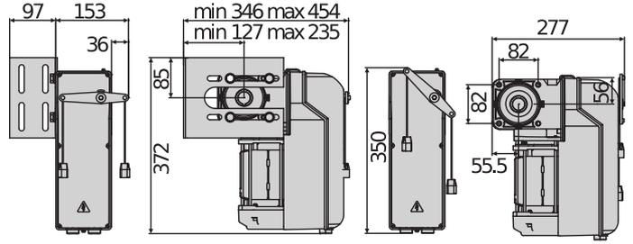
Yarı-yoğun kullanıma yönelik elektromekanik operatör 25 m<sup>2</sup>'ye kadar (Pegaso B Cja 625) veya 45 m<sup>2</sup>'ye kadar olan endüstriyel sekiyonel kapıların otomasyonu için.
