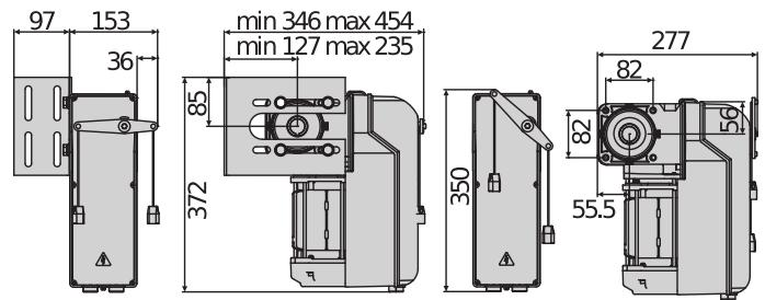
Elektromehāniskais motors vidēji intensīvai lietošanai, rūpnieciskiem sekciju tipa vārtiem līdz  $25\text{ m}^2$  (Pegaso B CJA 625) vai līdz  $45\text{ m}^2$ . Maksimālais atvēršanas ātrums 24rpm un maksimālais griezes moments 70Nm (Pegaso B Cja625); maksimālais atvēršanas ātrums 24rpm un maksimālais griezes moments 100Nm (Pegaso B CJA 645).
