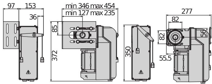
Operador electromecánico de uso semiintensivo para automatizar puertas seccionales industriales de hasta 25 m<sup>2</sup> (Pegaso B Cja 625) o hasta 45 m<sup>2</sup>. Velocidad de apertura máxima 24 r/min y par máximo de 70 Nm (Pegaso B Cja 625); velocidad de apertura máxima 24 r/min y par máximo de 100 Nm (Pegaso B Cja 645).
