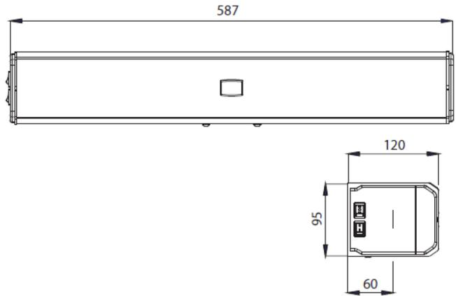
Gamme d'automatismes pour portes piétonnes à battants, adaptés également à un montage sur les entrées existantes et parfaits pour une utilisation intensive, avec des vantaux lourds et de grandes dimensions d'un poids maximum de 260 kg. Disponibles tant en gestion motorisée d'ouverture et fermeture que gestion de la fermeture à ressort de rappel.
