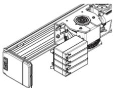
Possibilité d'insérer la batterie de secours également à l'intérieur de la version SXL.
