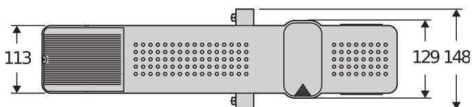
Elektromechanický pohon k rezidenčnímu použití pro automatizaci výklopných garážových vrat.
