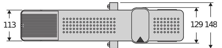
Opérateur électromécanique à usage résidentiel pour la motorisation de portes de garage basculantes.
