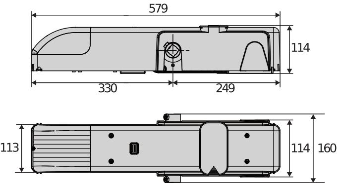
Yukarı açılır garaj kapılarının otomasyonu için mesken tipi kullanıma yönelik elektromekanik operatör.
