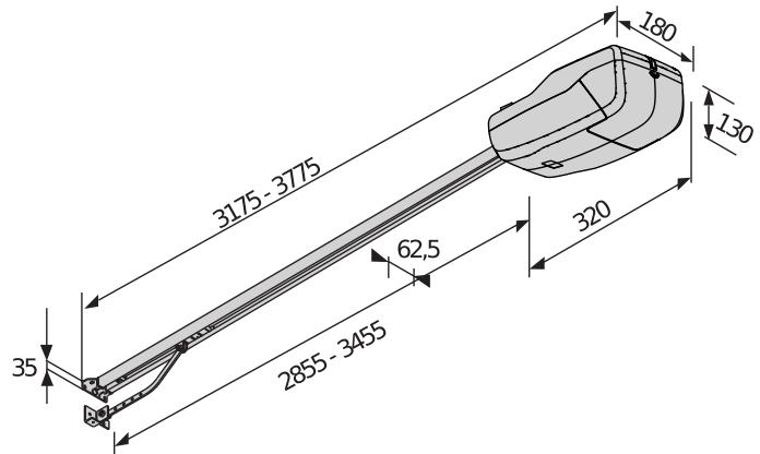
Sadece 13 santimetrelük kalınlığıyla TIZIANO piyasadaki en kompakt operatörlerden biri olup, her türlü mimari koşulda kurulumu imkan tanır. Kontrol ünitesi içerisinde yerleşik olarak bulunan telsiz alıcı sayesinde TIZIANO, 10 MITTO veya KLEIO serisi uzaktan kumanda ve/veya MIMEPAD veya T-BOX gibi kablosuz kontrol sistemleri için kod saklayabilir.
