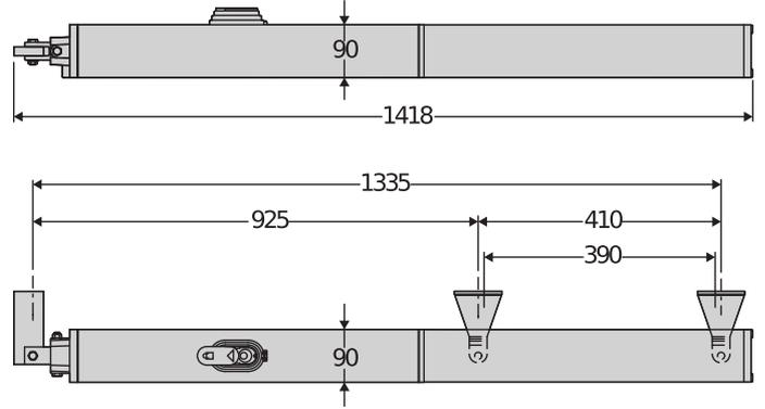
Sanayi tipi ve site tipi kullanıma uygun olağanüstü dayanıklı ve güvenilir oleodinamik operatörler. Azami 7 metre genişliğinde ve 500 kg ağırlığındaki kanatlı bahçe kapılarının otomasyonunu sağlayabilirler. Olağanüstü yüksek performanslı hidrolik sistemi ve kapama aşamasında yavaşlatma özelliği sayesinde akıcı ve sessiz kanat hareketleri garanti ederler. Çekme ve itme kuvveti ayarı baypas valf sistemi sayesinde hassas şekilde gerçekleştirilir.
