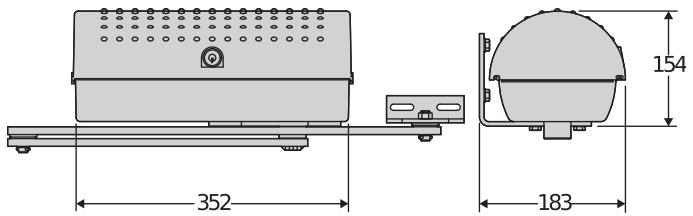
Azami 2.5 metre genişliğinde ve 250 kg ağırlığındaki kanatlı bahçe kapıları için uygun, mesken tipi kullanıma yönelik mafsallı kollu elektromekanik operatörler yelpazesi.
