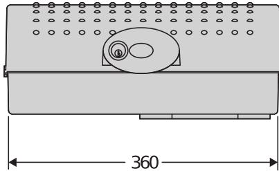
Asortiman nepovratnih elektromehaničkih uređaja 24V za krilna dvorišna vrata do 250 kg težine i 2,5 m duljine.
