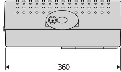
250 kg ağırlığa ve 2,5 m uzunluğa kadar kanatlı bahçe kapıları için ters çevrilemez elektro-mekanik 24 v operatör ürün yelpazesi. Azami 125° açılma sağlayan mafsallı kolları sayesinde büyük boyutlu sütunlar üzerine montaj için idealdir.
