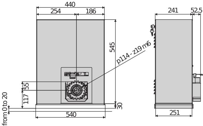
Moći, robusni operatori s trofaznim napajanjem od 400 V, posebno namijenjeni teškim vratima velikih dimenzija. Teška konstrukcija motoreduktora, štitnik od pocićanog i obojenog čelika te ugrađena središnja upravljačka jedinica čine ih idealnim rješenjem za sve situacije u industriji kada su pouzdanost i snaga od osnovne važnosti.
