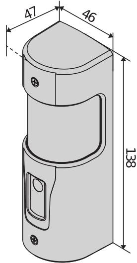
Беспроводные или проводные ориентируемые фотоэлементы с максимальной дальностью действия 30 метров.
