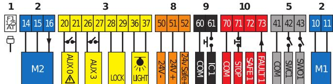
230V/200W üst garaj kapılarında kullanılan bir veya iki 24V elektromekanik operatör için ekranlı kontrol paneli.
