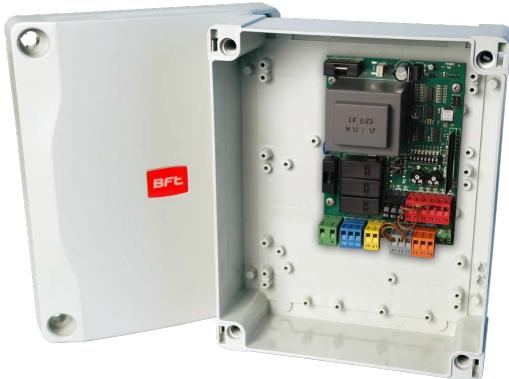
Panneau de commande à interrupteurs de programmation (dip switch) et potentiomètres pour un ou deux opérateurs 230 V/500 W utilisé sur les portails coulissants, battants, les volets et portes basculantes avec gestion jusqu'à deux bords (dont un de type 8K2).
