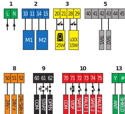
Steuerungseinheit mit Tippschalter für einen oder zwei elektromechanische 24 V-Antriebe, einsetzbar in Drehtoren mit 230 V/80 W.
