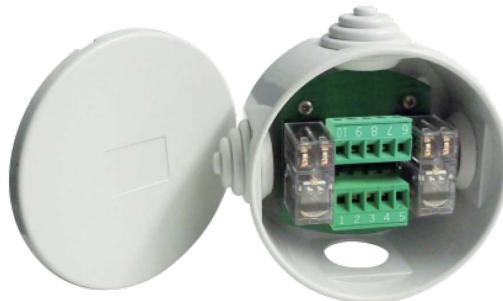
Scheda con alimentazione a 230V/1200W che permette di pilotare, tramite un deviatore a tre posizioni, fino a 2 motori per tapparelle oppure gruppi di motori.
