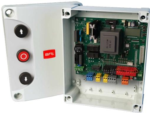
Panneau de commande avec afficheur pour un opérateur 230 V/750 W utilisé sur les portails coulissants, les portes sectionnelles industrielles et les barrières automatiques, avec fonctionnement de détection des obstacles possible grâce à un bord sensible ou encodeur BFT. Les entrées de commandes peuvent être configurées, le récepteur radio est inclus avec la technologie rolling code et les borniers sont colorés et extractibles afin de faciliter les opérations de câblage.
