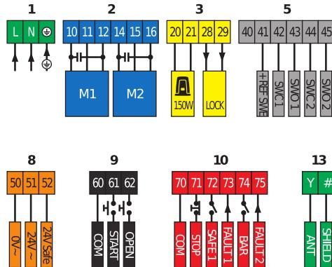
Kanatlı kapıarda kullanılan bir veya iki 230V/400+400W operatör ayar anahtarları ve potansiyometrelere sahip, endüstriyel katlanır kapıarda hassas kenar yönetimi ve güvenlik girişi onay seçenekli kontrol paneli.
