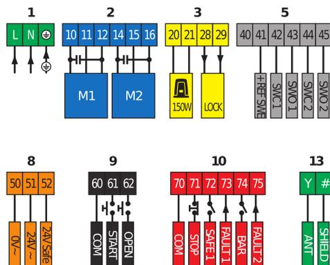
Vadības panelis ar bezkontakta slēdžiem un potenciometriem vienam vai diviem 230 V/400+400 W operatoriem, kurus izmanto ar viru vārtiem un rūpnieciskajām salokāmām durvīm, pārvaldot jutīgās malas un nodrošinot drošas iekļūšanas verifikācijas iespēju.
