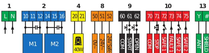
Vadības panelis ar DIP slēdžiem un potenciometriem vienam vai diviem 230 V 300 W operatoriem, kurus izmanto viru vārtiem, pārvaldot jutīgās malas, un ar drošas iekļūšanas verifikācijas iespēju. Tas var arī vadīt savienojumu ar EBP elektrisko slēdzeni vai ar ECB (ar papildu ME karti). Ritkoda tehnoloģija ir iekļauta radio uztvērējā. Spaiļu plātes ir krāsainas, un, lai atvieglotu vadu pievienošanu, tās var noņemt.
