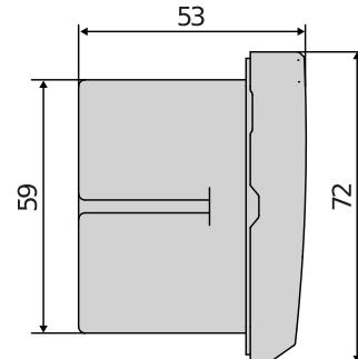
Par ulegnutih fotoćelija idealno je rješenje za elegantna rješenja koja se uklapaju u okruženje. Zbog njihove male veličine i mogućnosti prilagođavanja zrake, ugradnja je jednostavna. Produceni raspon glavnog napajanja 12 – 33 V AC i 15 – 35 V DC. Nazivni raspon od 30 metara.
