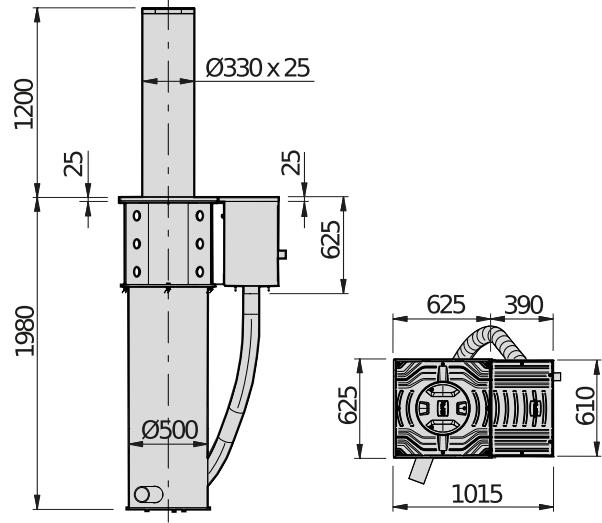
Automātisks hidrauliskais pretterorisma polers, kura pārbaudi un sertifikāciju (sadursmes tests) veica neatkarīga iestāde saskaņā ar standartu IWA14-1:2013 un PAS 68 (pielīdzināmi Amerikas standartiem K12 un K4) prasībām, piemērots sensitīvu vietu aizsardzībai. Neatkarīgs hidrauliskais vadības bloks katram poleram: ja viens vadības bloks tiek bojāts, pārējie poleri turpina funkcionēt, kamēr tiek veikti tehniskās apkopes darbi.
