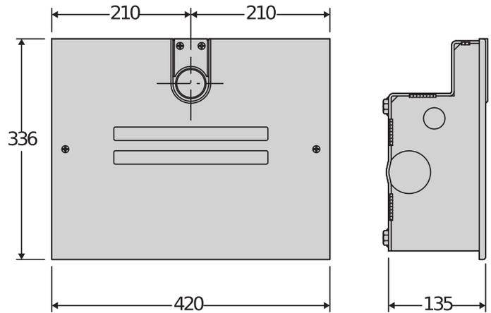
Pilns zemē ievietojamu, ar 24 V tehnoloģiju aprīkotu nereversīvo elektromehānisko operatoru klāsts veramiem vārtiem līdz 4 m garumā. Iestrādāti atvēršanas un aizvēršanas mehāniskie atduri atvieglo uzstādīšanu, jo nepieciešams mazāks fizisko atduru skaits. Ar kodētāju saistīta gala slēdžu sistēma nodrošina precizitāti un ātru uzstādīšanu. VELOCE versija nodrošina samazinātu gaidīšanas laiku atvēršanas un aizvēršanas laikā.
