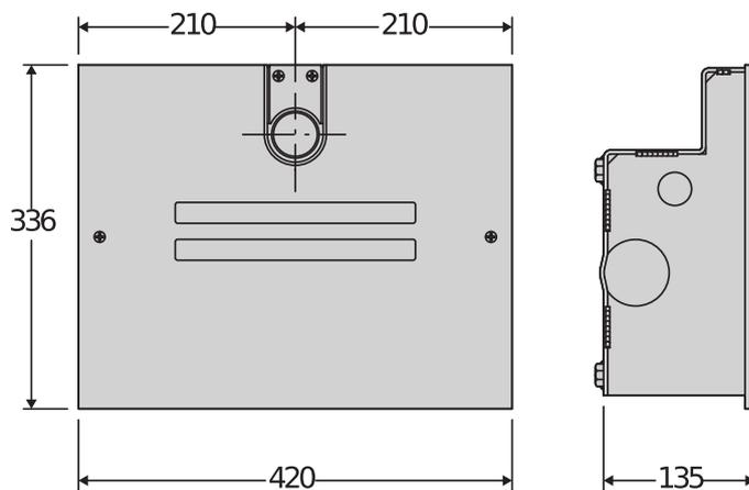
Cjeloviti asortiman nepovratnih podzemnih elektromehaničkih uređaja za krilna vrata dužine do četiri metra opremljena tehnologijom od 24 V. Integrirani mehanički zaustavljači za otvaranje i zatvaranje, a omogućuje se i mogućnost jednostavnog postavljanja smanjenjem potrebe za fizičkim zaustavljačima.
