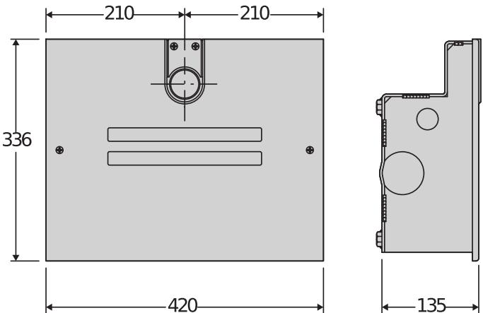
Täielik valik maaaluseid pöördumatuid elektromehaanilisi käitureid kuni 4 m pikkustele 24 V tehnoloogiaga tiibvärvavatele. Sisseehitatud mehaanilised stopperid, mis toimivad nii avamisel kui ka sulgemisel, on alati mootoris olemas ja võimaldavad täielikult nähtamatut paigaldust, eemaldades stopperid maapinnalt. Koodripõhine piirlülit Süsteem pakub täpsust ja kiiret paigaldamist. Versioon VELOCE pakub lühendatud ooteaega avamisel ja sulgemisel.
