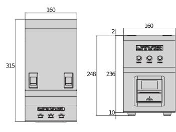
Настольное устройство проверки достоверности Espas 20-T представляет собой комплексное устройство для автономных систем, которое позволяет выполнять все функции обслуживаемой станции без необходимости прокладывания проводки и без использования ПК. Это устройство позволяет устанавливать тариф в зависимости от времени парковки. Также оно позволяет распечатать специальный талон, абонемент и отчет о доходах
