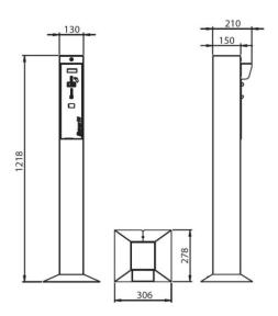
Autostāvvietu sistēmas iebraukšanas/izbraukšanas kolonna publiskai izmantošanai, kas darbojas autonomā režīmā. Iekārta nodrošina iebraukšanas un izbraukšanas kontroli, kuru var savienot ar elektromehānisko barjeru.
