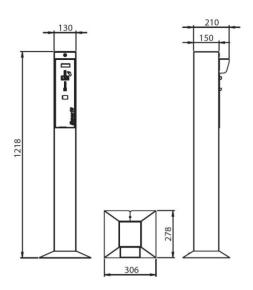
Stanowisko wjazdu/wyjazdu do systemów parkowania do użytku zbiorowego, działające w trybie "wolnostojącym". Urządzenie umożliwia kontrolę przejazdu na wjeździe lub wyjeździe i można je podłączyć do szlabanów elektromechanicznych.
