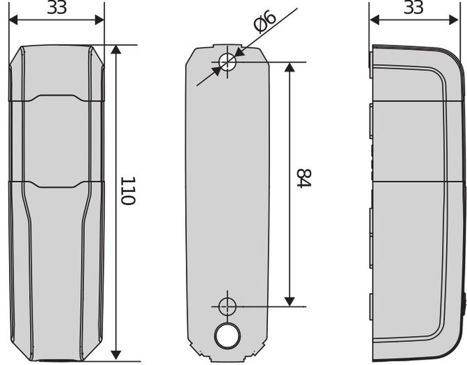
Ayarlanabilir fotosel çifti, kompakt boyutu sayesinde yüksek esneklik seviyesi sunacak şekilde tasarlanmıştır, kafa yatay, sola ve sağa 90° (toplamda 180°) ayarlanabilir ve 12-33Vac ile 15-35Vdc aralığında geniş bir giriş güç kaynağı. 20 metre nominal menzildir.
