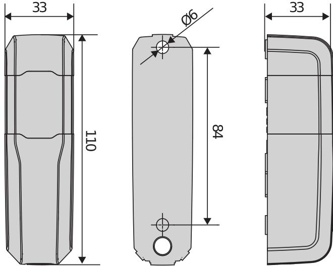
Par prilagodljivih fotoćelija, dizajniranih kako bi pružile visoku razinu fleksibilnosti pri postavljanju, a zahvaljujući svojoj kompaktnoj veličini, mogućnosti vodoravnog namještanja glave za 90 °, uljevo i udesno (ukupno 180 °) i širok raspon snage ulaznog napajanja, 12 – 33 V AC i 15 – 35 V DC. Nazivni raspon od 20 metara.
