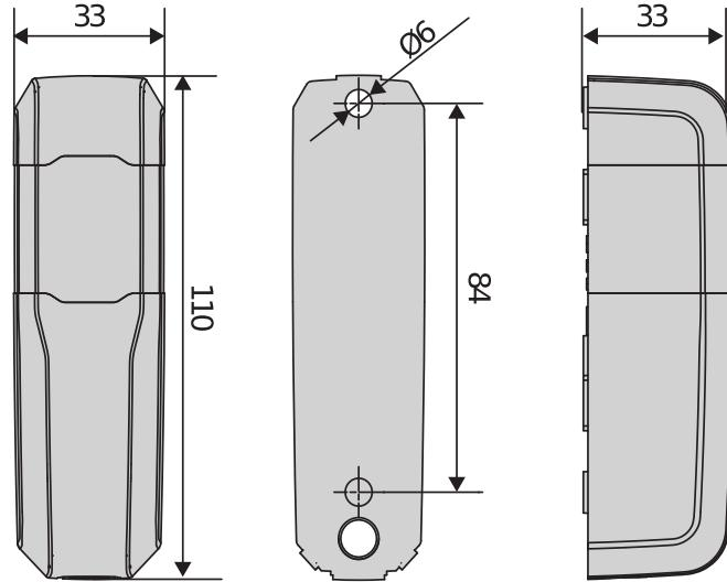
Pár nastavitelných fotobuněk navržených tak, aby nabídly vysokou úroveň flexibilita instalace díky kompaktní velikosti, možnosti nastavit hlavici o 90° vodorovně, vlevo a vpravo (180° celkem) a širokému rozsahu vstupního napájení 12–33 V střídavý proud a 15–35 V stejnosměrný proud. Nominální dosah 20 metrů.
