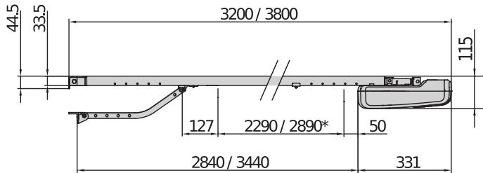
\* corsa utile / usable travel / course utile / nutzhub / carrera útil / werkstag
