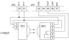
LOGICA test fotocellule OFF Photocell test LOGIC OFF LOGIQUE essai photocellules Désactivée LOGIK Test Fotozellen OFF LÓGICA prueba fotocélulas OFF LOGICA test fotocellen OFF
