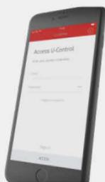
U-Control est la nouvelle application de Bft qui permet de commander un ou plusieurs automatismes compatibles avec u link équipés d'une carte d'extension B-Eba Wi-Fi. L'utilisateur peut via Internet ouvrir/fermer/arrêter l'automatisme directement avec son smartphone ou sa tablette (Android ou iOS) tout en sachant en temps réel son état (ouvert/fermé) quel que soit l'endroit où celui-ci se trouve.
