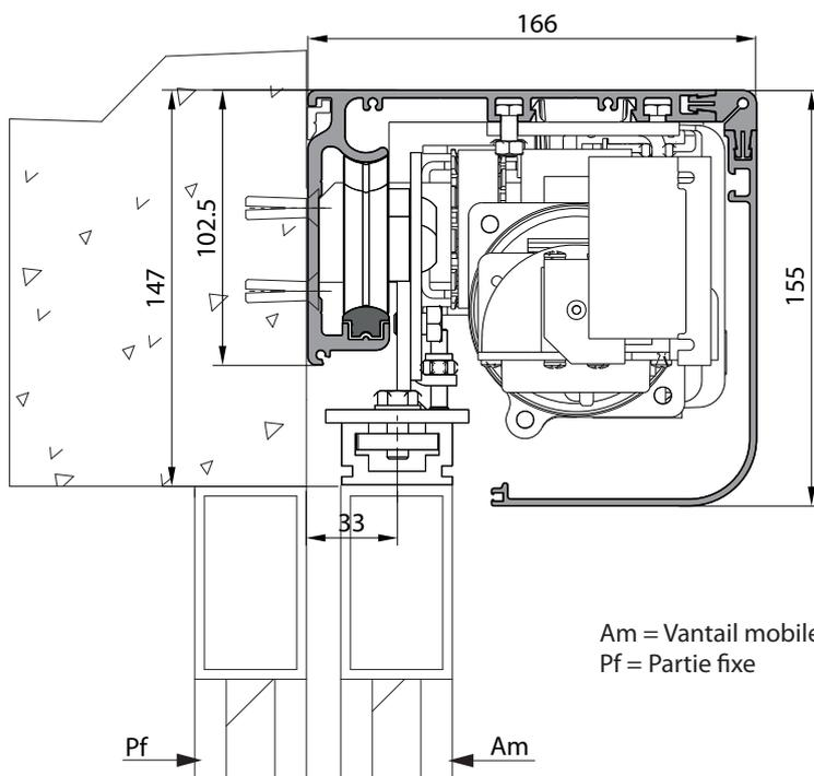
L'automatisation est combinée à des profils surdimensionnés avec une poutre de 151 x 102,5 et un boîtier frontal en aluminium anodisé de 155 mm.
