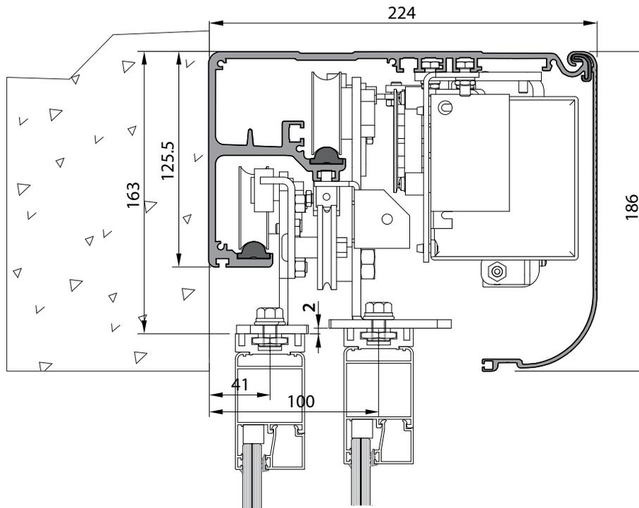
L'automatisation est combinée à des profils spécifiques avec une poutre de 224 x 125,5 et un boîtier frontal en aluminium anodisé de 186 mm.
