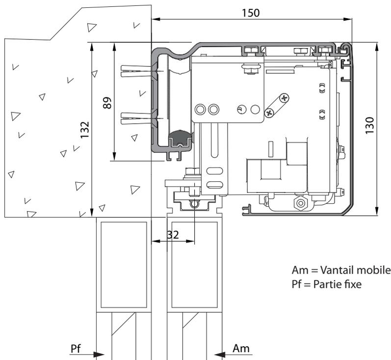
Tous les modèles de la gamme sont combinés avec la traverse de 89x150 mm et le boîtier frontal de 130 mm en aluminium anodisé.
