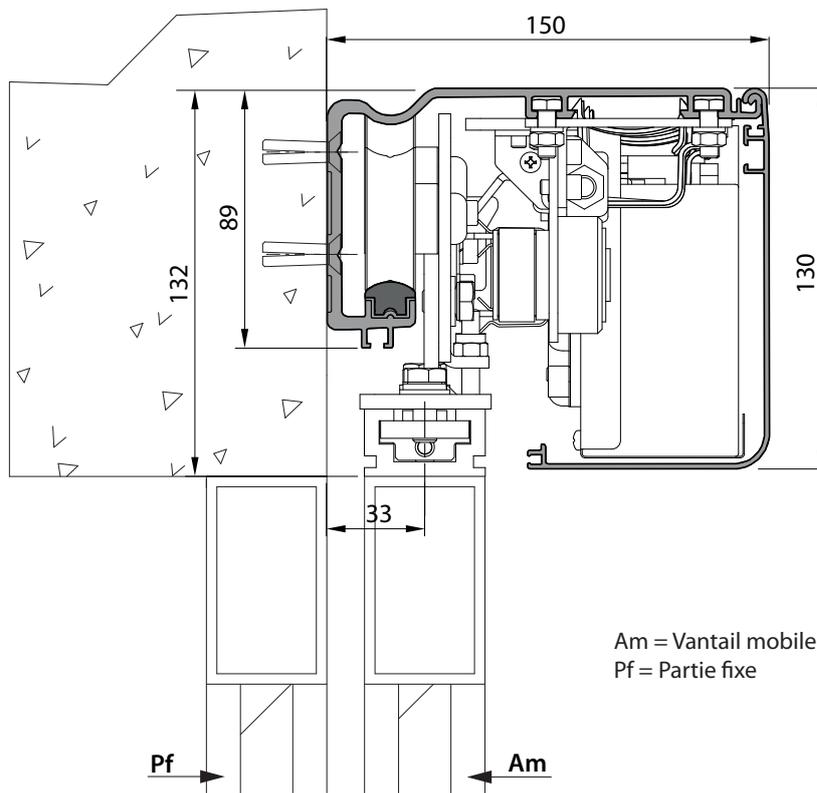
VISTA EMERGENCY doit être combinée avec les profils compacts VISTA SLK.
