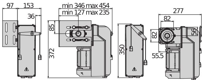
Elektromechanický pohon pro polointenzivní použití pro automatizaci průmyslových sekčních vrat až  $25 \text{ m}^2$  (Pegaso B Cja 625) nebo až  $45 \text{ m}^2$ . Maximální rychlosť otevírání 24 ot/min a maximální točivý moment 70 Nm (Pegaso Cja625 B); maximální rychlosť otvárania 24 ot/min a maximálny točivý moment 100 Nm (Pegaso B Cja 645).
