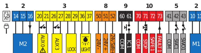
Ekraaniga juhtpaneel ühe või kahe 24 V elektromehaanilise käituri jaoks, mida kasutatakse 230 V / 200 W garaaži tõstuste jaoks.
