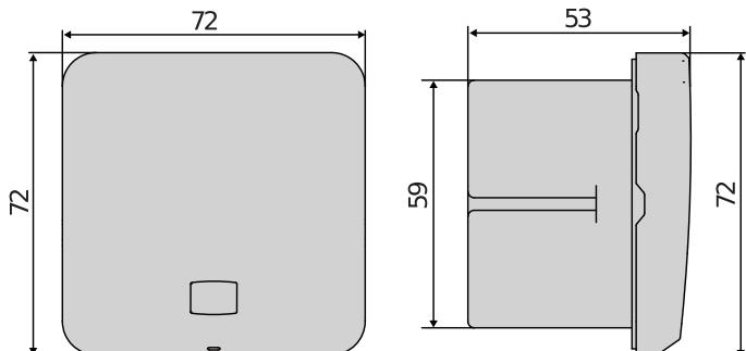
Dvojice zapuštěných fotobuněk, ideální stylové řešení, které dokonale zapadne do okolí. Díky své malé velikosti a schopnosti nastavit paprsek znamená snadnou instalaci. Rozšířený hlavní napájecí rozsah 12–33 V AC a 15–35 V DC. Jmenovitý dosah 30 metrů.
