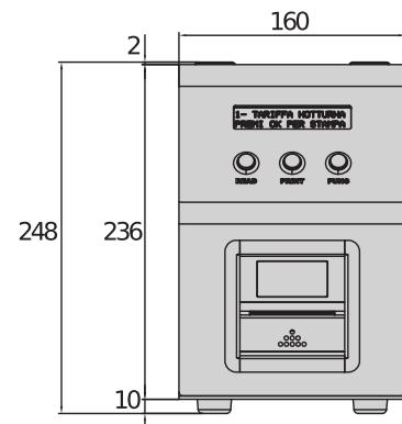
Le validateur de table ESPAS20-T est un dispositif tout-en-un pour systèmes autonomes qui offre toutes les fonctionnalités d'un poste de garde, sans câblage ni PC.
